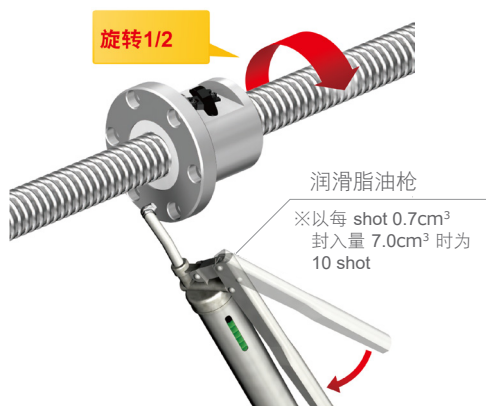
图 4-1 使用润滑脂油枪封入
